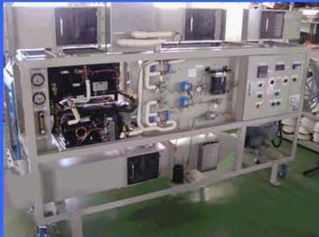
冷凍機をヒートポンプシステムとして運転し、空気調和の実験を行う装置。ヒートポンプは熱移動による冷却技術と、熱回収によって加熱を行う省エネルギー技術です。
