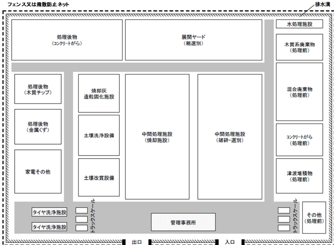
図6-3 仮設焼却炉・破砕機等を含む二次仮置場のレイアウト例 (参考：対策指針)
