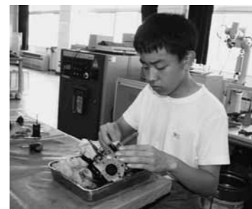
【写真上2枚】部品の取り外しやサビ取り、洗浄をコツコツと行いました。ネジがサビでいて取り外しも一苦労でした。
