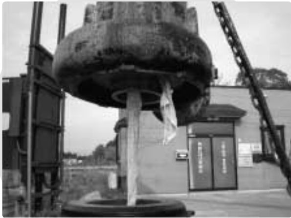
【流れてきたタオルがからまり、止まってしまった揚水ポンプ】
