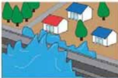
堤防に水が過度に浸み込んだり、堤防が河川の流れにより侵食（けずられる）されて堤防が決壊し水があふれ出します。
